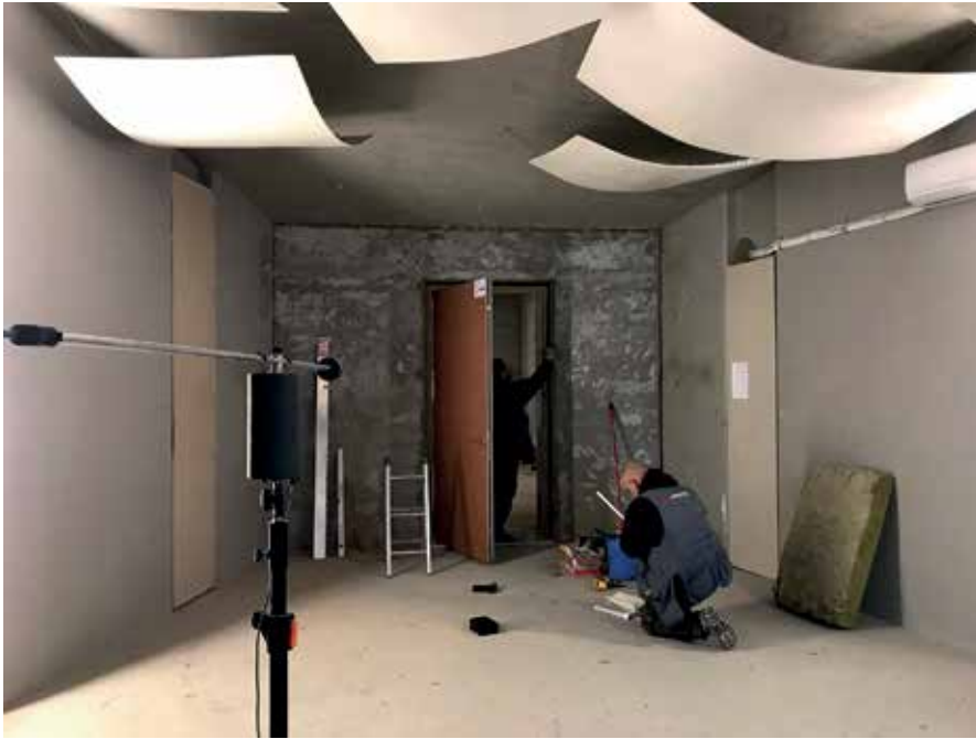
Installazione di un campione in laboratorio per una prova di fonoisolamento (courtesy Z-Lab)
