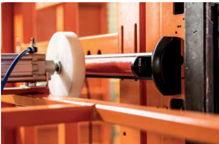
Test ciclico di un maniglione antipanico (EMEA Testing Lab)
