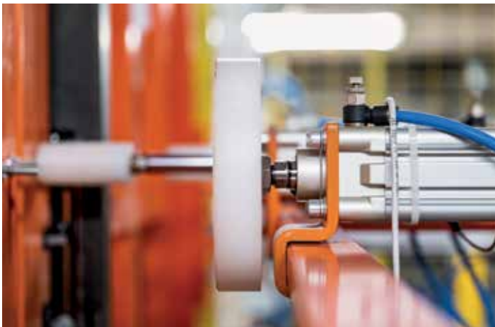
Elettropistone per prove di durabilità (EMEA Testing Lab)
