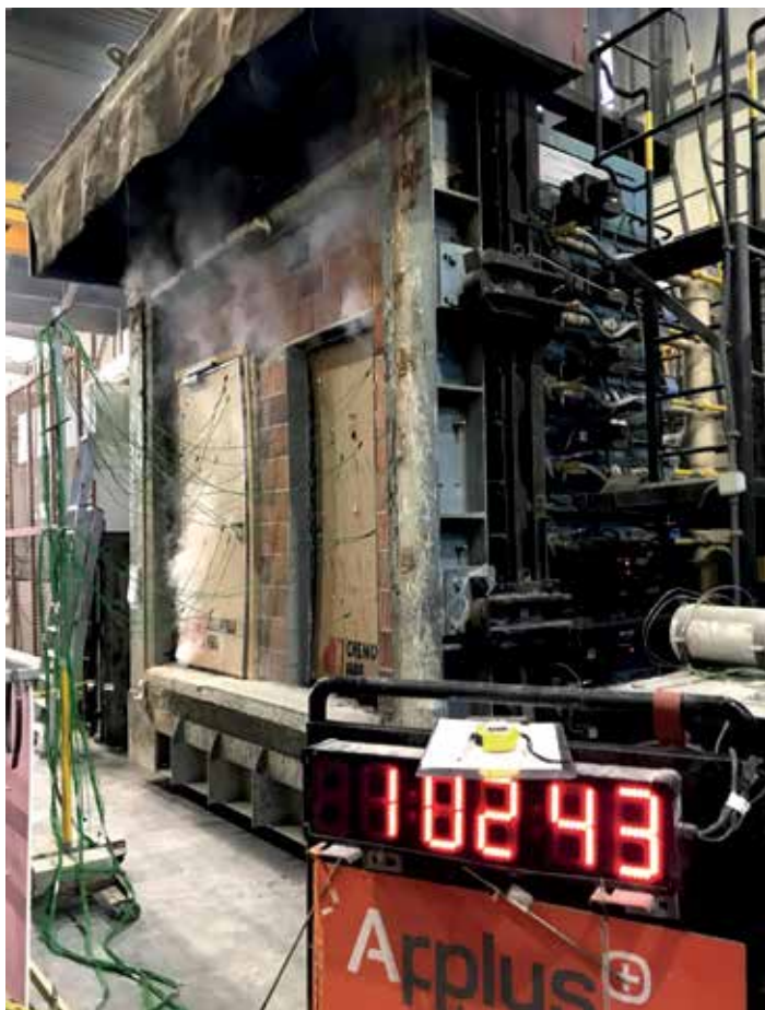
Prova al fuoco di serratura per portoncini blindati (EMEA Testing Lab)
