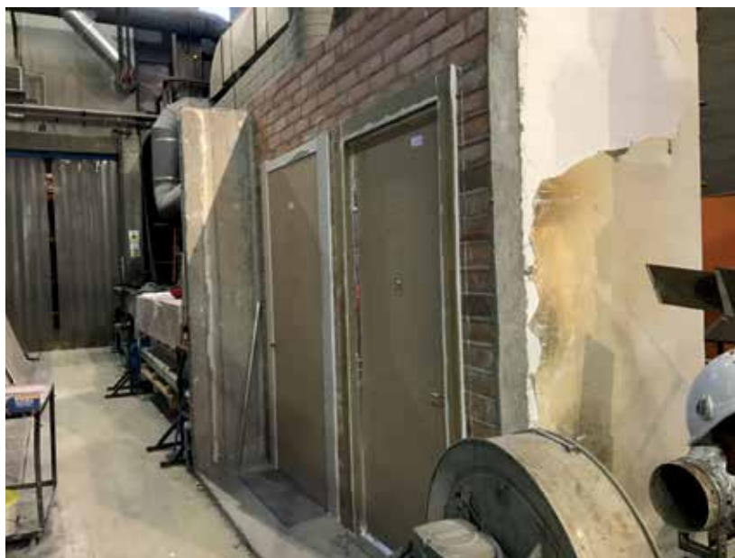
Test di tenuta al fumo presso laboratorio Applus, Barcellona
